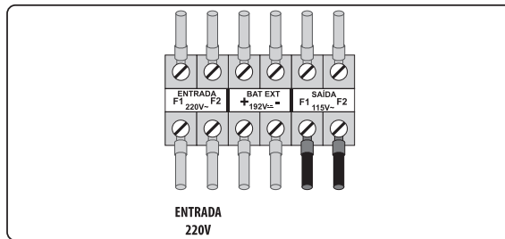
FIGURA 4 - Bitola dos cabos conforme Tabela 1 (cabos de rede de entrada)
