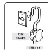
**! IMPORTANTE:** Em uma rede elétrica 220V~, bifásica, é necessário instalar um disjuntor bipolar para proteção de cada uma das fases, conforme a figura ao lado:
