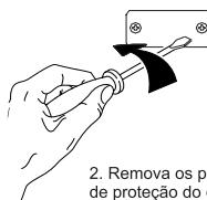
2. Remova os parafusos da tampa de proteção do conector do nobreak ou do módulo de baterias.
