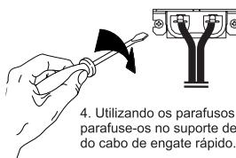
4. Utilizando os parafusos removidos, parafuse-os no suporte de fixação do cabo de engate rápido.
